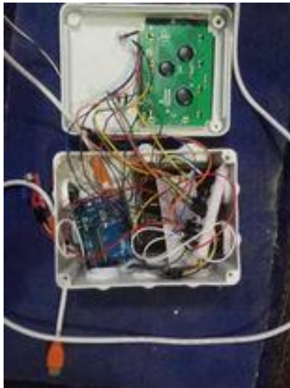
شكل رقم(2) وحدة تحكم دقيقة اردوينو لجمع بيانات المستشعر
